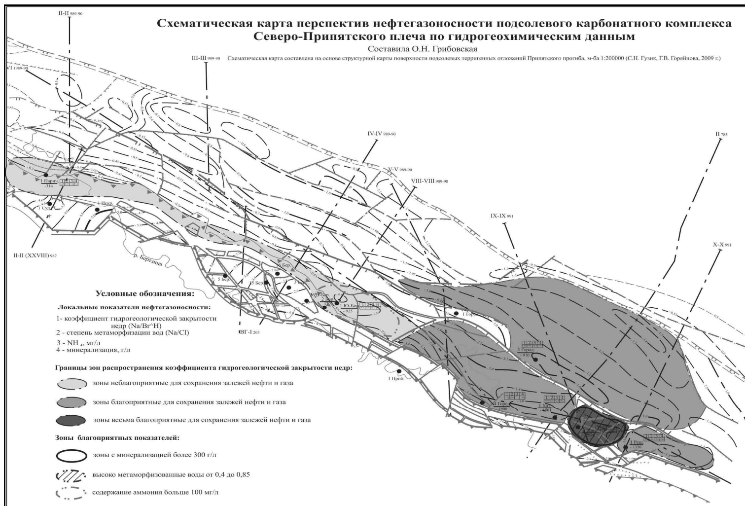
Рисунок – Схематическая карта перспектив нефтегазоносности подсолевого карбонатного комплекса Северо-Припятского плеча по гидрогеохимическим данным
