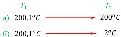
В данном случае процесс (а) является более близким к равновесному, чем процесс (б), т. к. в случае процесса (а) температура распределена более равномерно, чем в случае процесса (б).
