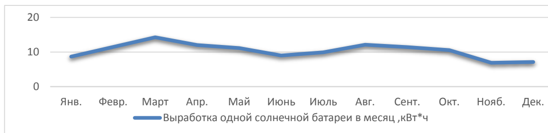
Рисунок 3 – Сезонная выработка одной монокристаллической солнечной батареи
